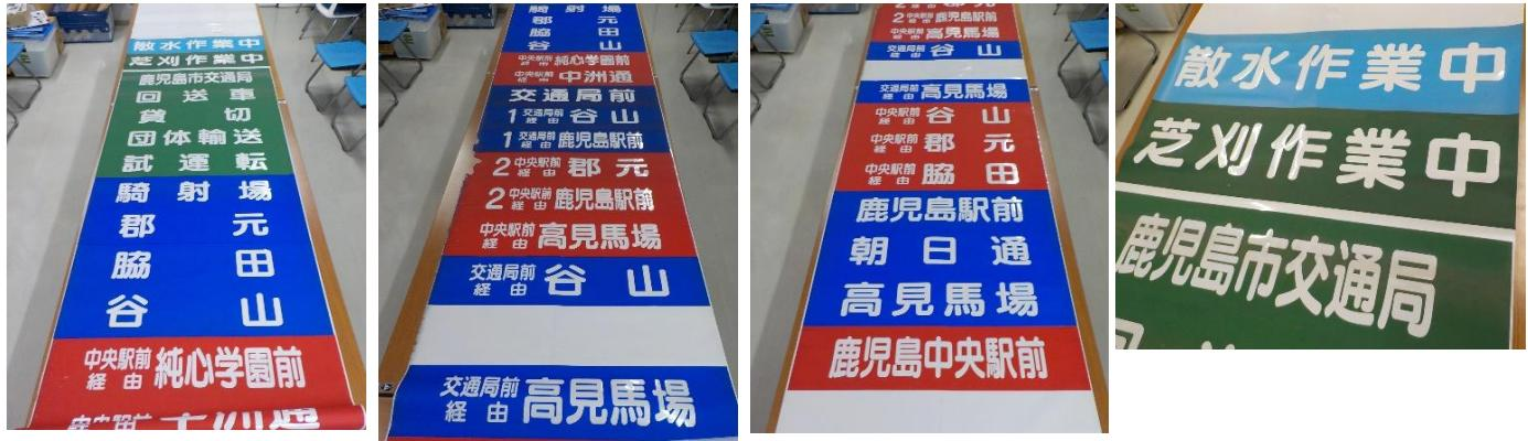
平成22年3月から令和5年11月まで市電軌道敷の芝刈及び散水業務で使用していた散水電車512号の方向幕になります。「散水作業中」「芝刈作業中」といった業務内容が表記してある散水電車専用の方向幕です。
