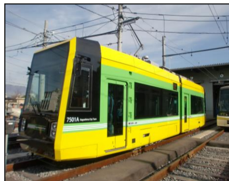
⑩7500形 新型超低床電車 【平成29年～31年製造 4両】
