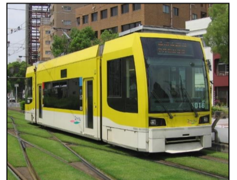
⑧1000形 国産初の超低床電車 【平成13年～17年製造 9両】
