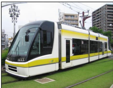
⑨7000形 接続式超低床電車 【平成19年～20年製造 4両】
