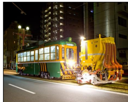
⑮散水電車・芝刈装置 【平成22年3月改造 1両】
